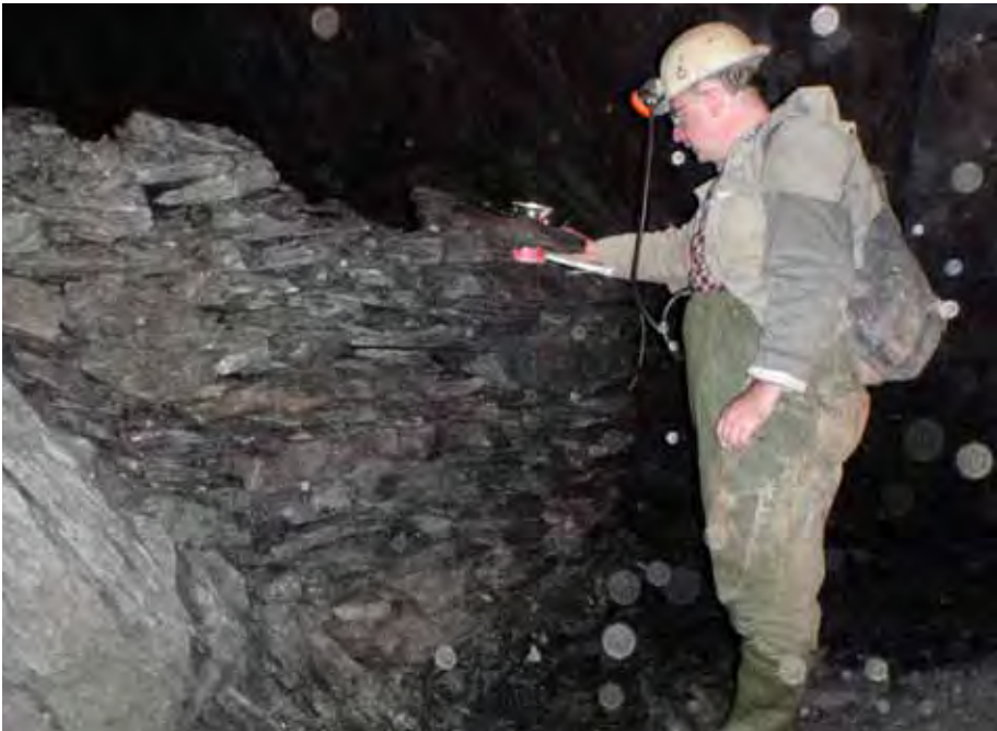
Abb. 10: Die Schiefergrouf vu Schläif lässt sich nur mit Wathosen befahren, da vorne bis 1 m hoch Wasser steht. Die Luftfeuchte ist so hoch, dass Wassertröpfchen ausfallen und im Foto reflektieren. Foto: Zahlmann.
