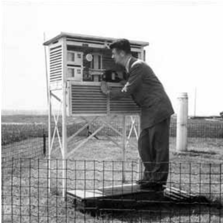
Photo 1. Abri météorologique de type Stevenson et pluviographe à augets basculeurs (à l'arrière plan) en vigueur au début des années 1950 sur le site de l'aéroport de Luxembourg. Photographie issue des archives du Service Météorologique de l'Aéroport (avec autorisation de M. Claude Alesch, chef du SMA).
