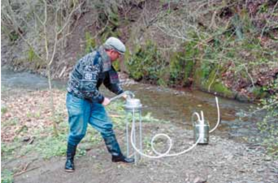
Abb. 2-3: Die modifizierte Interstitialpumpe nach Bou-Rouch im Einsatz an einem Bach in Luxemburg. The modified Bou-Rouch interstitial pump at work on the bank of a stream in Luxembourg.
